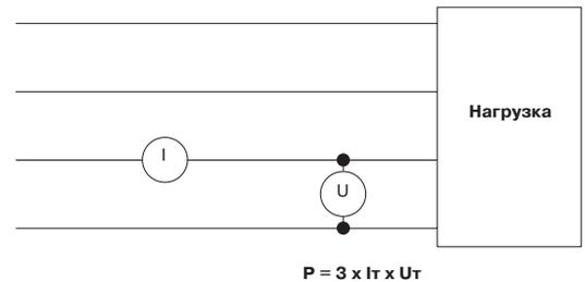
В трехфазных системах метод с одним счетчиком активной энергии дает верные результаты только при симметричной нагрузке на фазы. Но так как на практике идеально сбалансированные системы встречаются весьма редко, этот метод не следует использовать для получения точных замеров.
