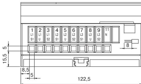
Район контактов, счетчик прямого подключения
