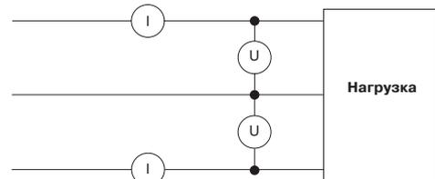
Метод с двумя счетчиками активной энергии используется в трехфазных системах без нейтрального проводника, независимо от симметричности или асимметричности нагрузки.
