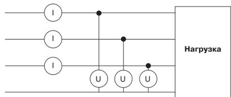
Метод с тремя счетчиками активной энергии обычно используется в трехфазных системах с нейтральным проводником. Данный метод подходит для асимметричных и симметричных нагрузок.
