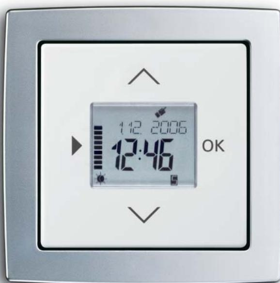
Комфортный элемент управления таймером Серия выключателей: solo®.
