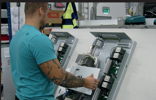
Окончательная сборка централизованных аккумуляторных систем для аварийного освещения.
