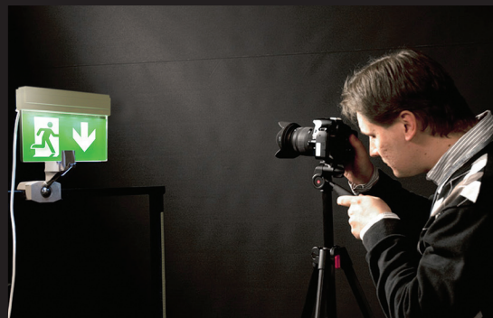
Контроль световых приборов осуществляется в собственной лаборатории освещения Teknoware в соответствии с требованиями стандартов.
