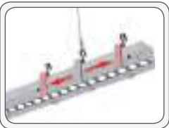
Продольная регулировка подвешного крепежа
