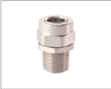
Кабельный ввод M20x1,5 под небронированный кабель d = 6-12 мм, Артикул: LE 1234
