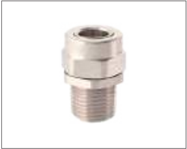
Кабельный ввод M20х1,5 под небронированный кабель d = 6-12 мм, Артикул: LE 1234
